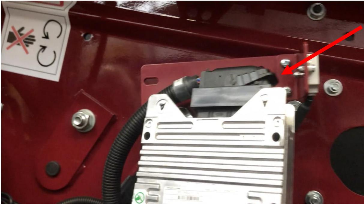
14) Le boîtier de commande doit être branché et testé.
